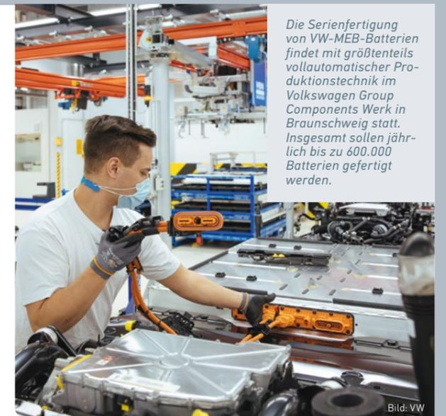
Die Serienfertigung von VW-MEB-Batterien findet mit größtenteils vollautomatischer Produktionstechnik im Volkswagen Group Components Werk in Braunschweig statt. Insgesamt sollen jährlich bis zu 600.000 Batterien gefertigt werden.
