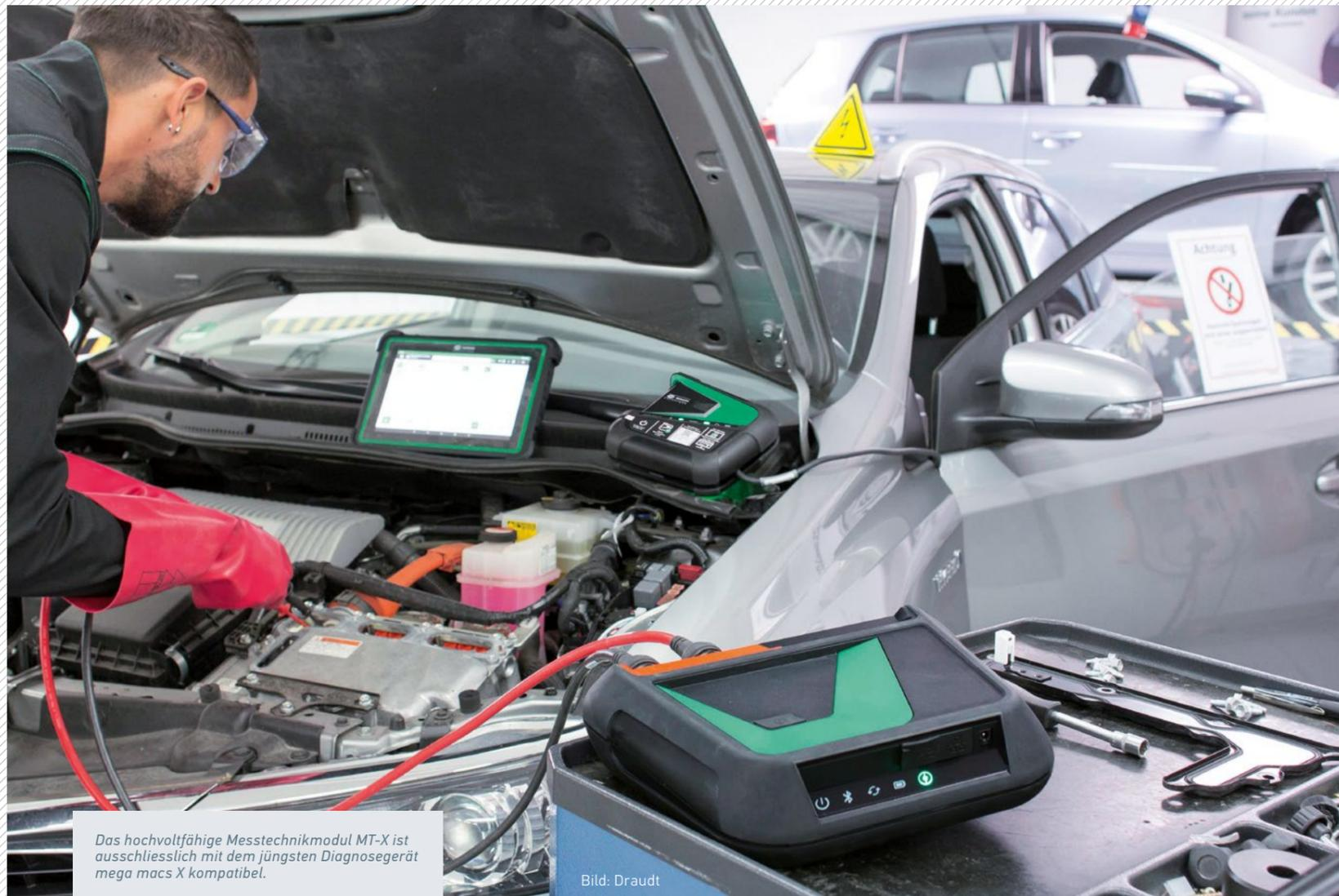
Das hochvoltfähige Messtechnikmodul MT-X ist ausschließlich mit dem jüngsten Diagnosegerät mega macs X kompatibel.
