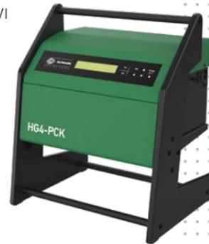
Das neue Zusatzgerät HG4-PCK von Hella Gutmann ist voll kompatibel mit dem aktuellen Abgasmessgerät mega compaa HG4 und operiert nach dem DC-Prinzip (Diffusion Charging). Das heißt, die Partikelanzahl wird durch elektrisches Auf- und Entladen der Partikel ermittelt. Dabei handelt es sich um das werkstattgerechtere der beiden gängigen Verfahren. Neben deutlichen Vorteilen bei den Kosten werden außerdem keine Verbrauchsmaterialien benötigt.
